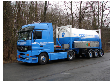
ISO-Container für den CO 2 -Transport
