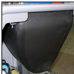
Isolierter Trockeneisbehälter mit einer Kapazität von 23 kg
