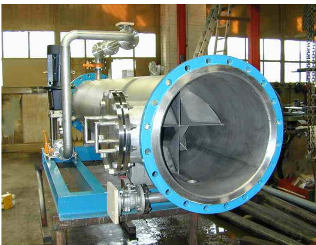
CO 2 -Zufuhr in den Hauptwasserstrom über den Teilstrom
